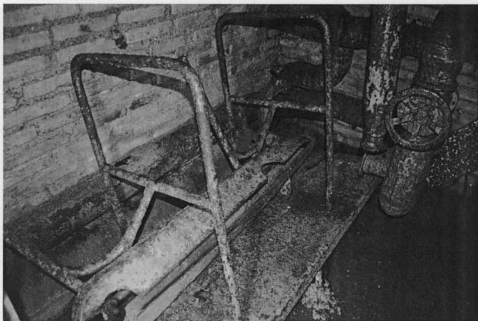
**Figura 9- Bicicletta per il ricambio dell'aria**
